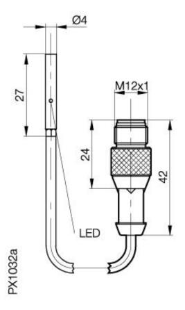
Induktiver Näherungsschalter BES 516-3007-G-E4-C-S 4-00,2 D4 x 27 **Schließer** Sn=1,5mm bündig einbaubar
